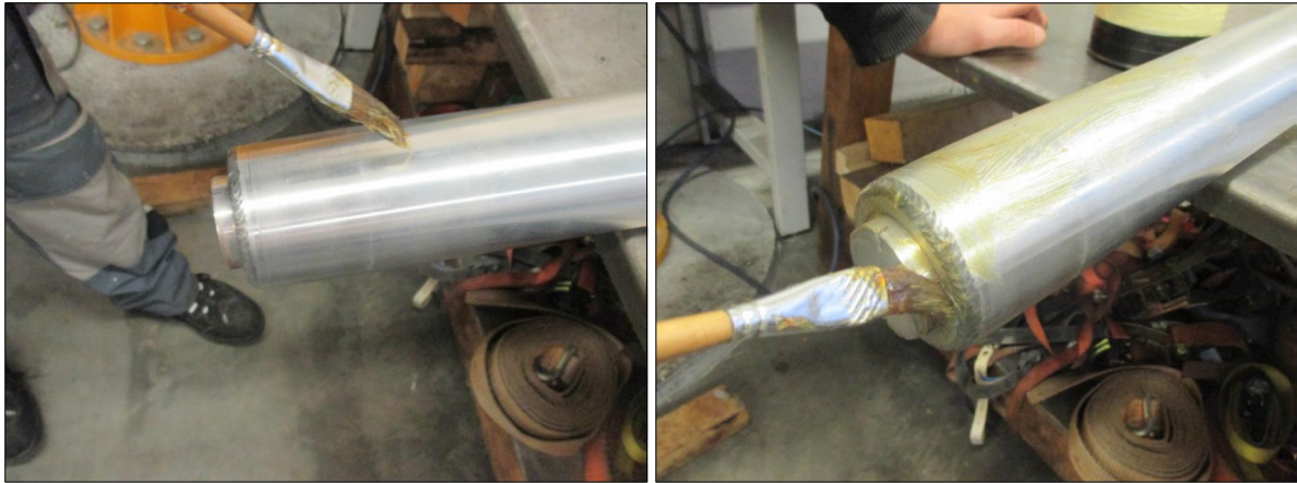
图 52 在铝管和定心处涂上润滑脂
