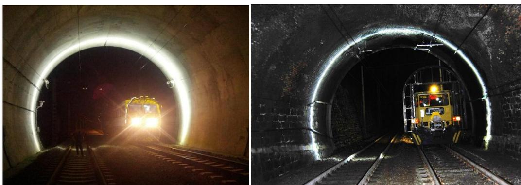
图 6 – 检测车辆在采集作业时的照片
