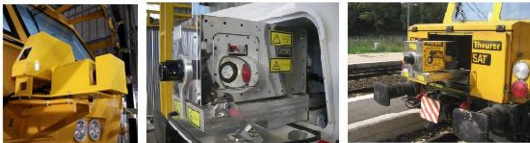
图 9 – 激光轮廓仪的各种车辆安装图片
